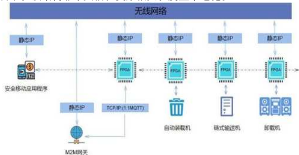
图 1 通过 FPGA 实现两层连接 这种架构的好处是降低了与主 FPGA 系统的通信带宽, 释放处
