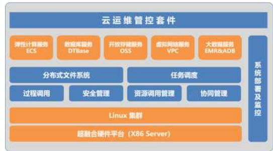
图2 分布式云计算大数据平台体系架构图
