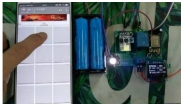
图 3 ESP8266 控制 3W 小灯示意图
