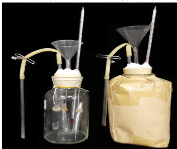
图1 绿色植物的呼吸作用探究实验“三合一”实验装置
