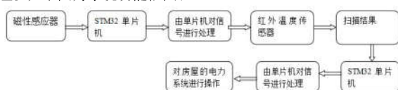
图 1: 基于 STM32 单片机的智能门禁系统功能流程图
