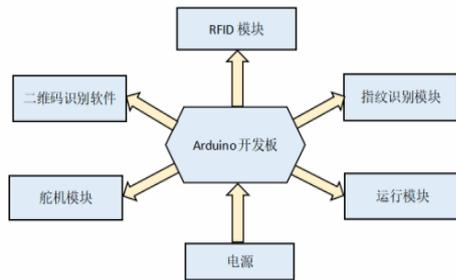
该门禁系统主要是由 ic 卡门禁系统和指纹门禁系统两部分。此系统基于 arduino uno R3 单片机, 并通过 ST89C51 芯片进行数据传输。通过提前输入, 增加, 修改, 删除, 将相关信息存储入数据库中, 当使用者将 ic 卡进入射频识别范围或者指纹信息录入识别模块时, 芯片将查询数据库, 若信息合法则向舵机模块传输信息; 若不合法则关闭。
