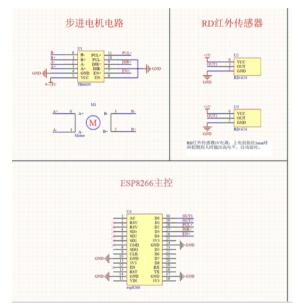
选择 ESP8266 开发板作为控制器,红外传感器将捕捉到的信号传输给控制器,经过控制器处理,执行相应的功能,控制主电路,步进电机,带动机构,以达到门帘自动开合的目的。
