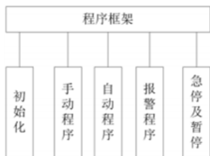
图 2 变位机“控制框架”
