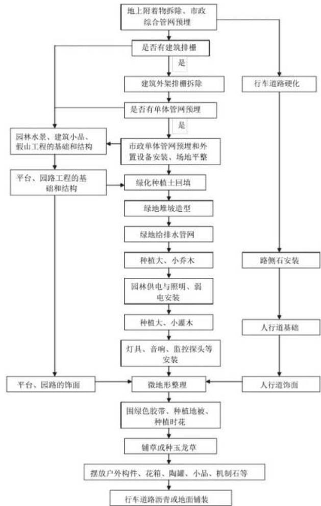
图2 风景园林施工流程
