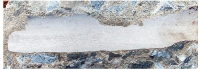
图5. 高质量、压实良好的混凝土在超过80年的连续海上暴露后破裂的示例，显示了与直径为 32 mm 的钢筋接触的无空隙表面（为清晰起见，已移除）。沿整个 5-7 m 钢筋未检测到腐蚀（照片 ©RE Melchers, 2020）。
