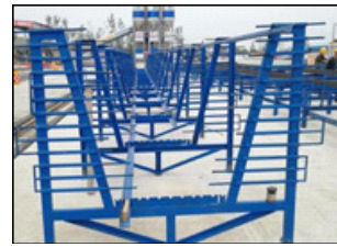
钢筋绑扎胎架示意图
