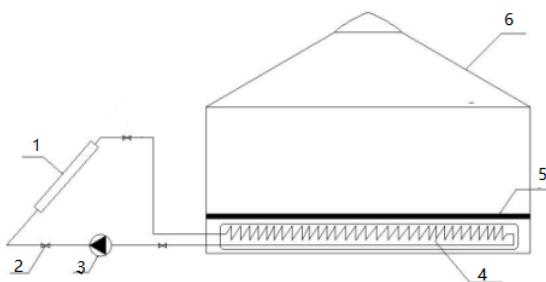
图 2 太阳能—热水供暖系统示意图
