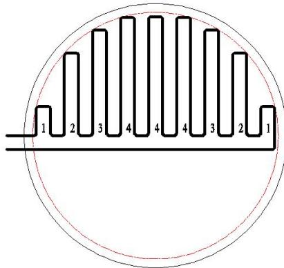
图 3 毡房底部辐射供热管道示意图
