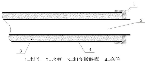
图 4 相变储热装置示意图
