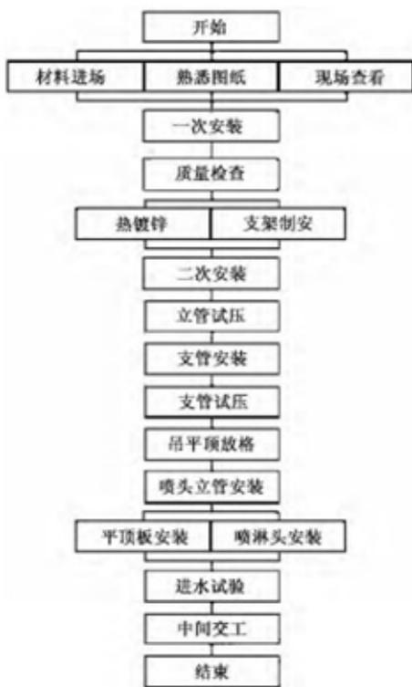
图1 消防喷淋设备施工流程
