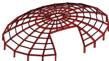
图 1: 开口穹顶结构三维图
