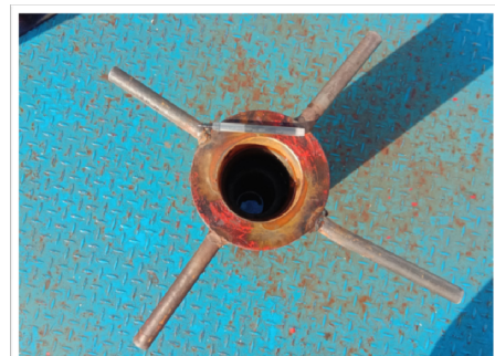
图3: 全通径泄流通道抢接装置
