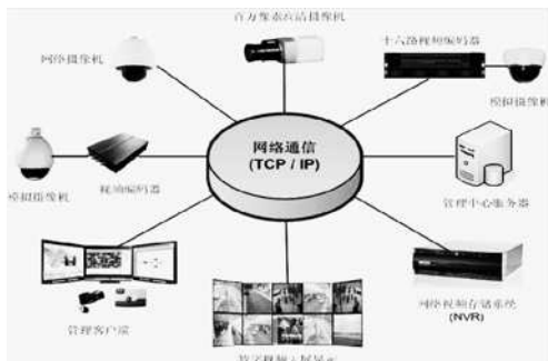
图 2 网络监控系统架构图
