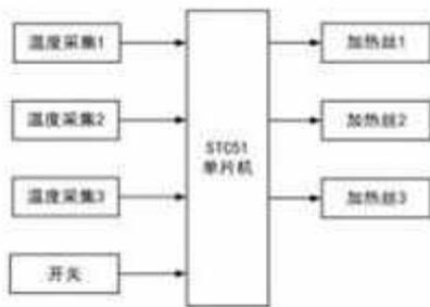
图 1 恒温加热系统框图
