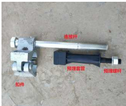
图一 连墙件组成部分
