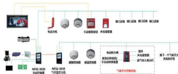
图 1 某地铁车站 FAS 系统
