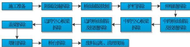
图1 施工工艺流程图
