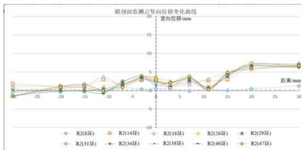
图 10 R2 断面点地表竖向位移曲线图
