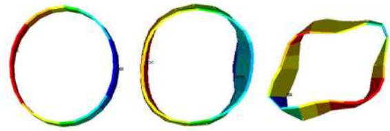
图 2.2 不同压实度下管截面变形图
