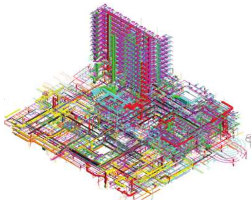
图1 机电项目BIM全专业模型
