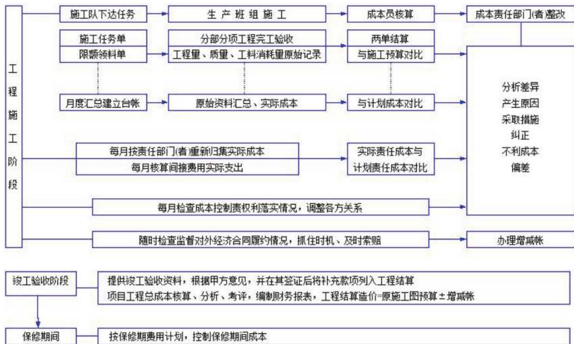
图1 施工阶段成本控制流程图
