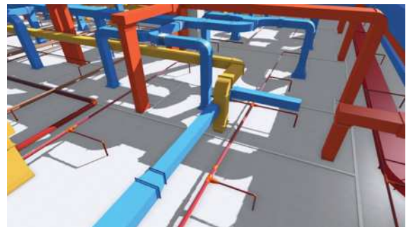
图4 构件碰撞检测
