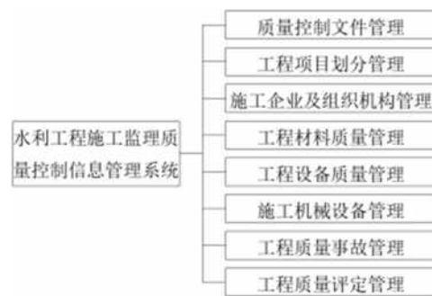
水利工程施工监理质量控制信息管理系统
