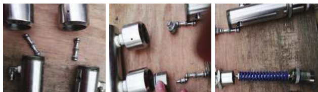
图2 高低压限位阀拆解图
