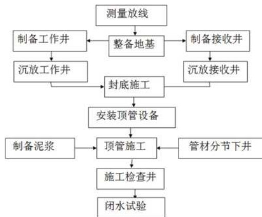
图1 顶管施工工艺流程
