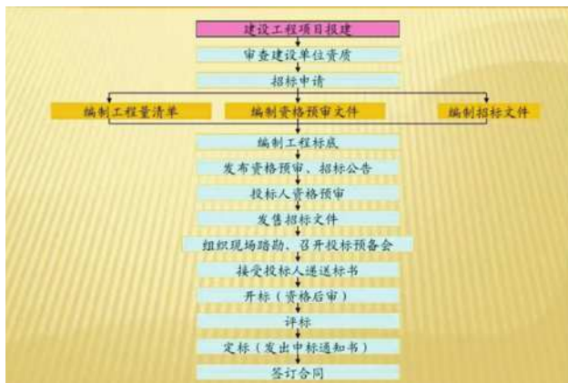
图1 建筑工程招投标流程
