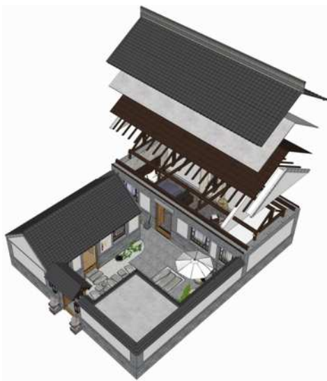
图8 房屋结构爆炸图
