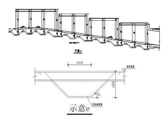
③棚架直接设置在覆土内。根据上部建筑的防倒塌范围,有时候棚架会伸出坡道一段距离,这个时候棚架底部柱墩会独立在覆土内。如果覆土下仍有地库顶板,则可能部分柱墩高度不满足锚栓锚固长度要求,地库顶板上仍需在短柱墩下设置转换梁,转换梁设置原则可参见①类棚架,;如果柱墩下无地库顶板,且与坡道结构底板无连接,可设置矩形柱墩,方便施工,详见下图示意f,短柱(JZ)或柱墩(JC)配筋由设计计算确定,设置独立柱墩时,车库顶板上要同时考虑《人民防空地下室设计规范》GB50038-2005表4.8.2的核武器爆炸动荷载作用下常用结构等效静荷载和防倒塌棚架的钢柱柱底内力在覆土中的折算荷载。
