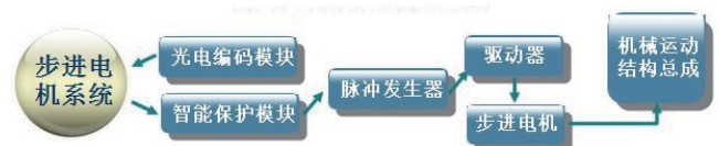
图3 机器人运动机构工作原理图
