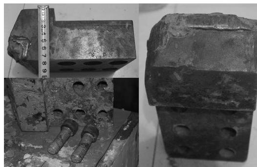
图4 磨损脱落的刀具
