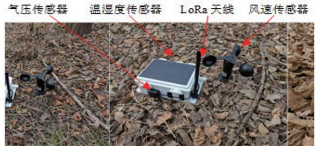
图3 系统硬件实物图
