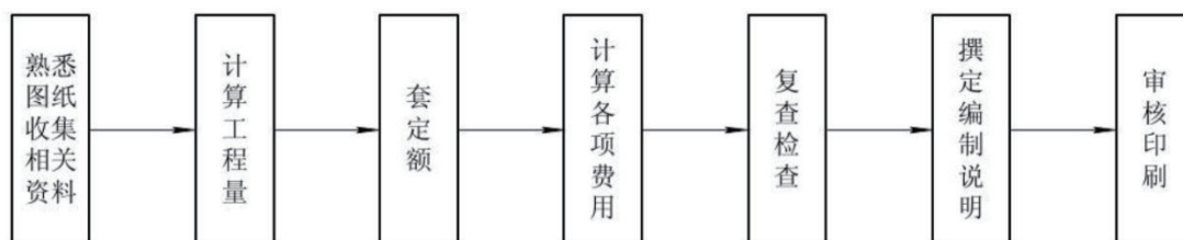
图1 公路工程造价编制设计概算流程图
