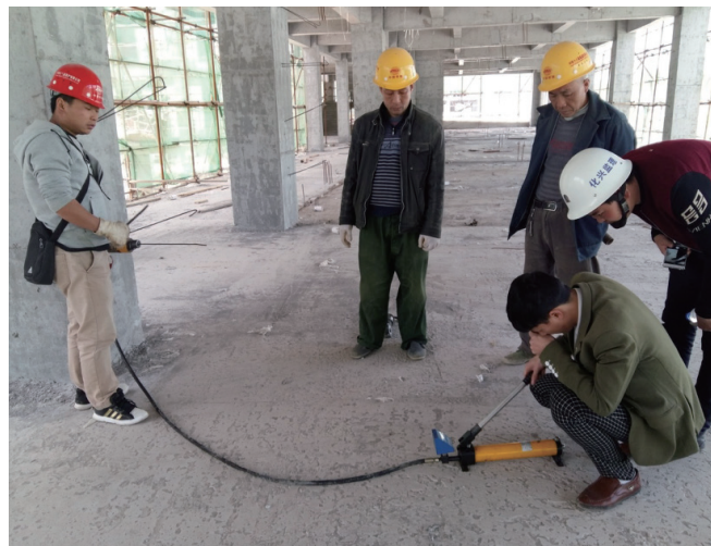
图7 一层柱7轴交A轴植筋拉拔试验
