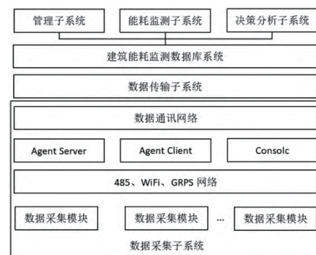
图1建筑能耗监测系统体系结构
