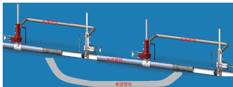
图1 主动密封不停输封堵工艺示意图
