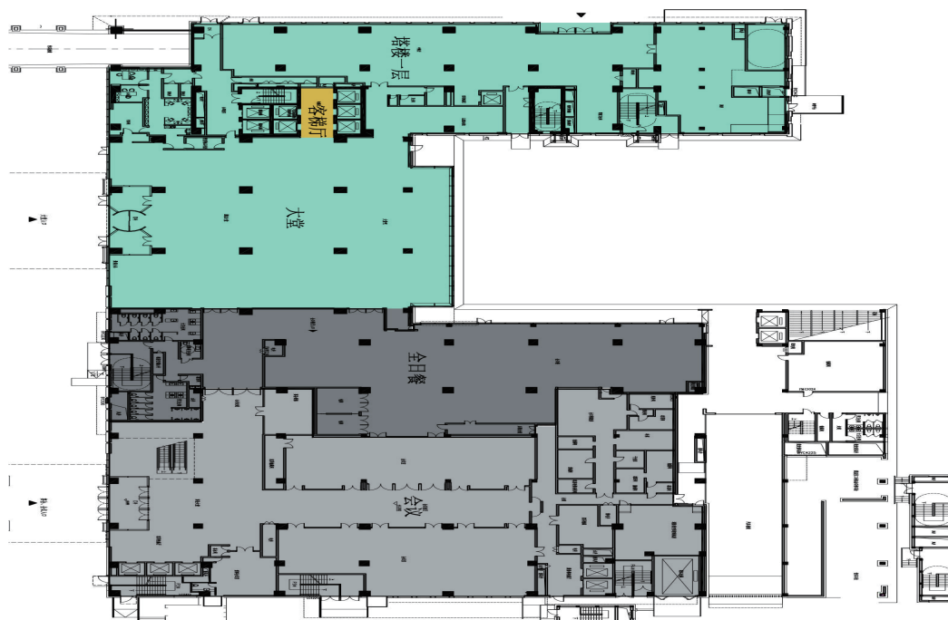
图2 高层与裙房防火分区平面划分示意图
