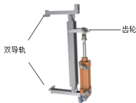
图2 气缸双导轨机构
