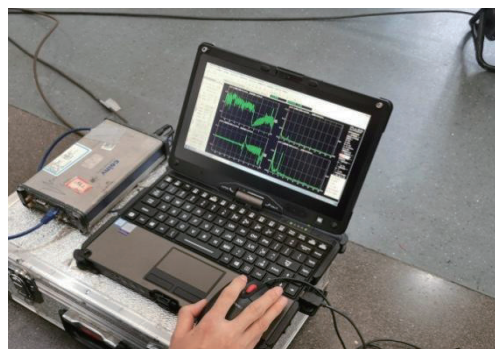
图8 QZ250型支座3Hz测力传感器响应图
