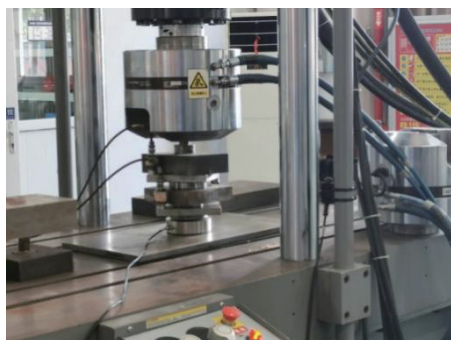
图9 QZ250型支座测力传感器测试
