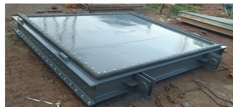
图2 经过热喷涂处理后的钢闸门
