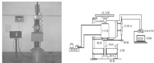
图 1 表面压实振动仪 图 2 静力贯入试验装置
