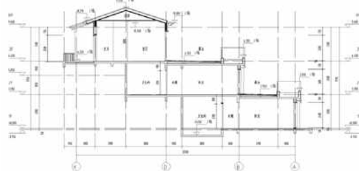
图 2.1 三层爬山墅结构剖面图
