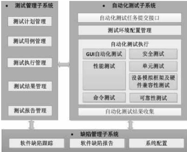
图1 自动化测试平台体系结构
