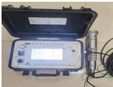
图3 YWZ8 型微震监测仪及检波器
