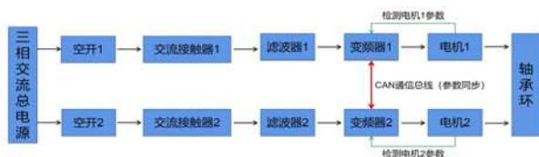
图 4 天线驱动系统供电流程
