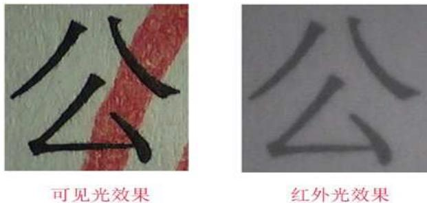
图2 激光打印文字在文检测仪的红外光源下观察笔画未消失
