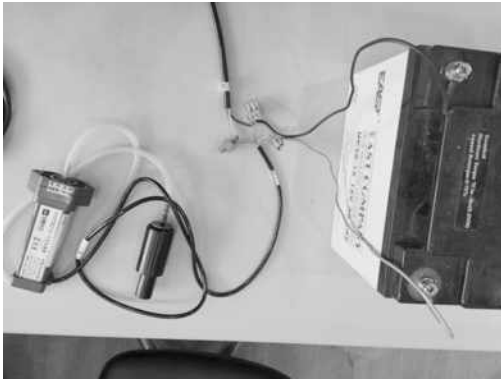
图 1 气压传感器电器连接图
