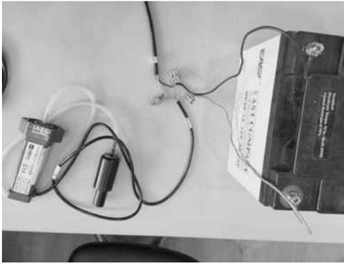
图 1 气压传感器电器连接图
